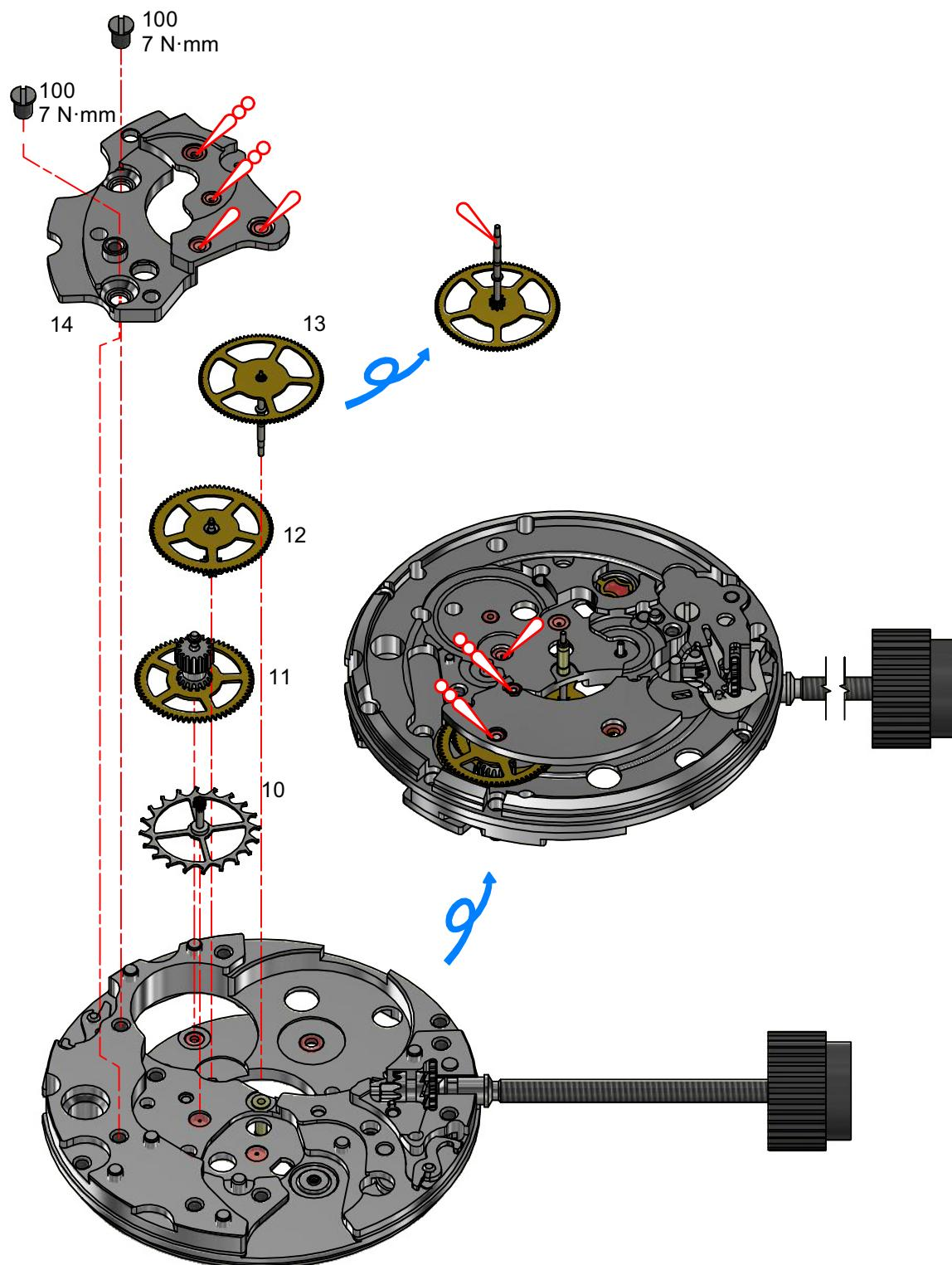
**Montage mouvement – Werkmontage – Assembling of the movement :
